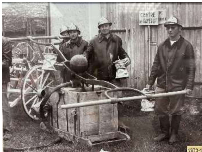
Pompe à incendie avec bêche en bois et sphère en cuivre (Pour éviter le jet saccadé)
