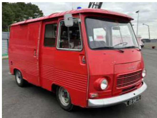
Ce véhicule destiné aux interventions diverses est un J7 Peugeot, mis en service en 1980. Sa cabine est approfondie par un compartiment d'équipage.
