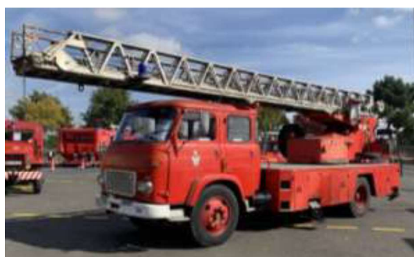
Echelle pivotante de 30 mètres. Il s'agit de l'EM 59 de la Brigade de sapeurs-pompiers de Paris. L'ensemble "échelle Magirus et porteur Saviem SM8" est exceptionnel, la quasi-totalité des Saviem SM8 ayant porté des échelles Metz et Riffaud.
