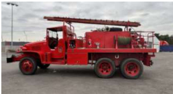
Camion-citerne lourd pour feux de forêt, avec un équipement Sides, réalisé pour l'armée. La motopompe est également de la marque SIDES.
