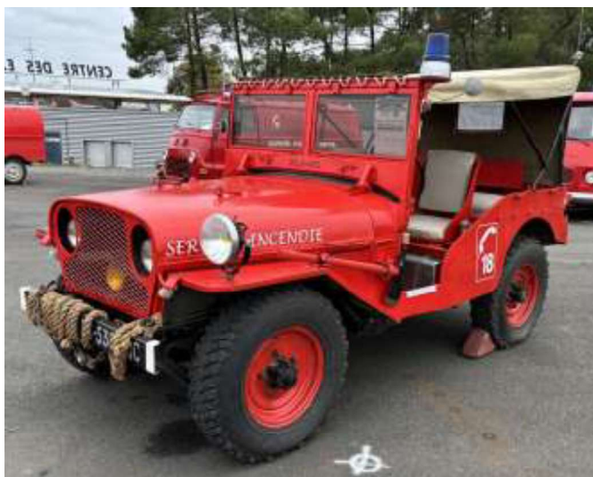
Véhicule de reconnaissance sur VLR Delahaye n° 0095. Son affectation probable était au 93 ème Régiment d'Infanterie en 1944. Elle est équipée d'un moteur 4 cylindres de 1992 cm 3 – 63 CH.
